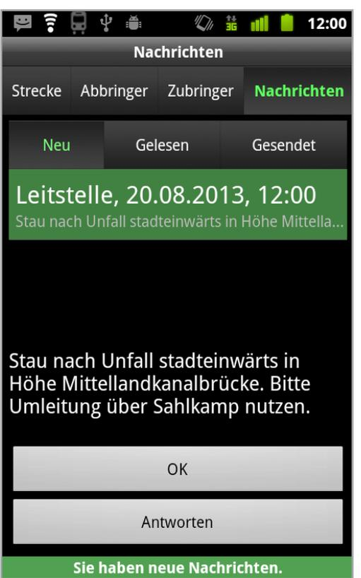
Will der Fahrer mit der Leitstelle oder anderen Fahrzeugen kommunizieren, greift er auf dynamisch generierte Telefonbücher zurück: Per Knopfdruck stehen so alle relevanten Kontakte zur Verfügung. Im Reiter „Nachrichten“ finden sich alle empfangenen und gesendeten Textmeldungen (rechts).
