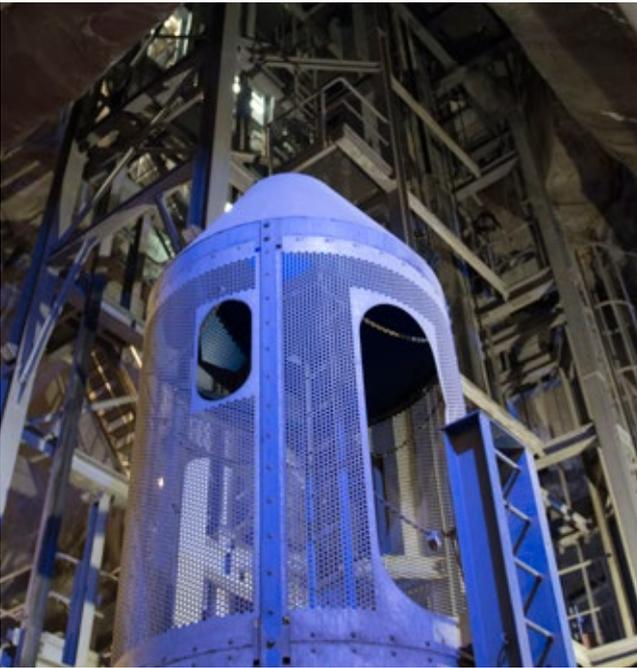
Sedrun: Nach der Demontage der Schachtförderanlage (im Bild) wird im nächsten Jahr die definitive Hebeeinrichtung installiert.
